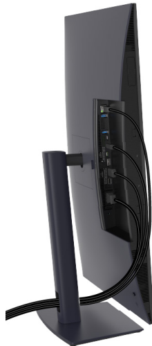
Малюнок 31. Підключіть кабелі в найвищому, максимально поверненому положенні
