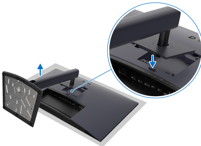
Малюнок 64. Зняття стійки монітора
